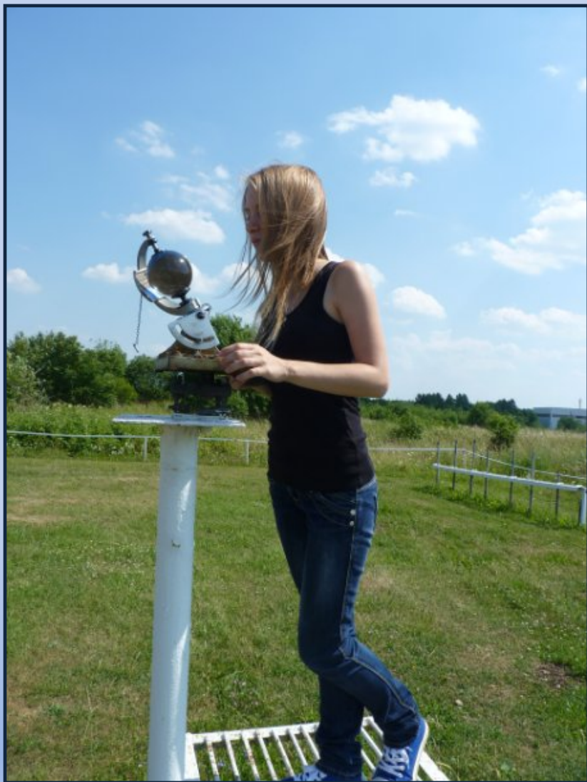
Определение продолжительности солнечного сияния в течение дня с помощью гелиографа
