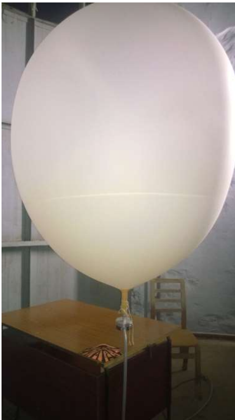
Наполняемый водородом шар, который мы впоследствии использовали для запуска аэрологического зонда.
